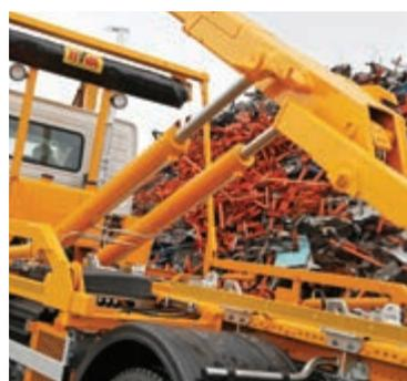
「コンビ」ロックング・システムが全てのタイプと大きさのコンテナを確実に固定します。
